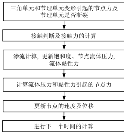
图 2 修改后的 FDEM-flow 方法的求解流程图 Fig.2 Flow chart of the modified fluid-solid coupled FDEM-flow method
