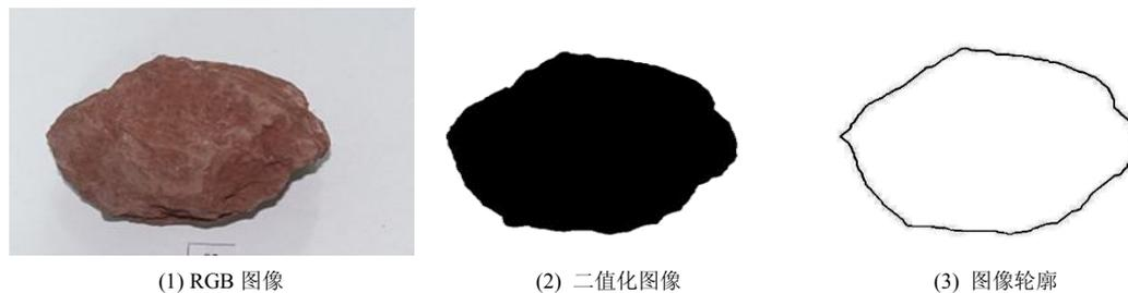
图 6 MATLAB 分步处理颗粒图像结果
