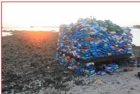
图1 礁坪相地基平板载荷试验
