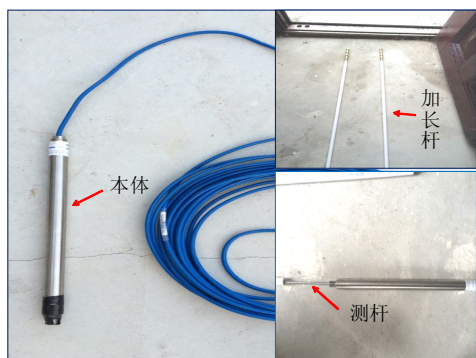
图 11 位移计现场拼装图
