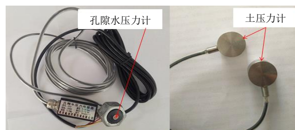
图 3 孔隙水压力传感器和土压力传感器 Fig.3 Water pressure sensor and earth pressure sensor
