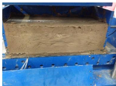
图 7 土体剪切破坏
