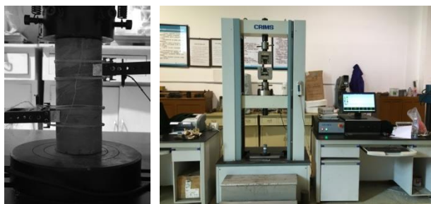
图 2 DNS100 微型控制电子万能试验机 Fig.2 Computer-controlled electronic versatile testing machine DNS100
