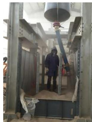
图 12 砂雨法施工
