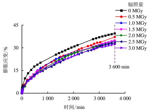
图 10 不同辐照剂量下自由(无荷)膨胀应变-时间曲线
