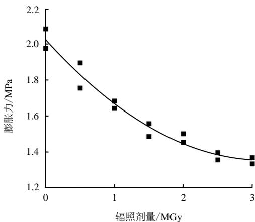
图 9 膨胀力随辐照剂量变化曲线
