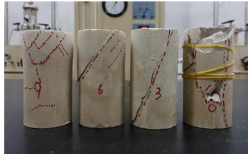
图 6 对照组膨润土破坏形态图
