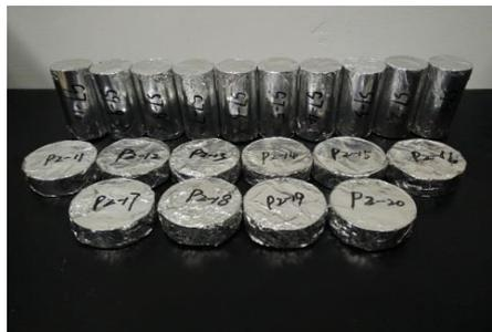
图 2 包锡箔纸试样
