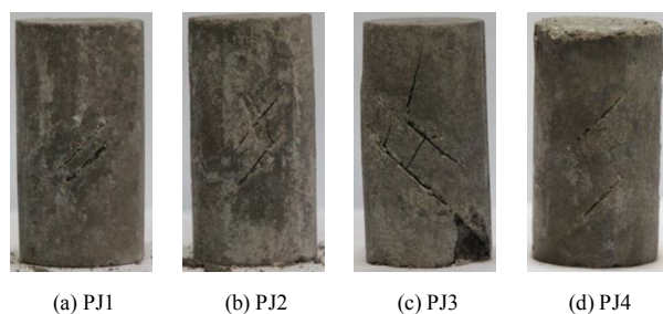
图 5 平行双裂隙岩体破坏形态
