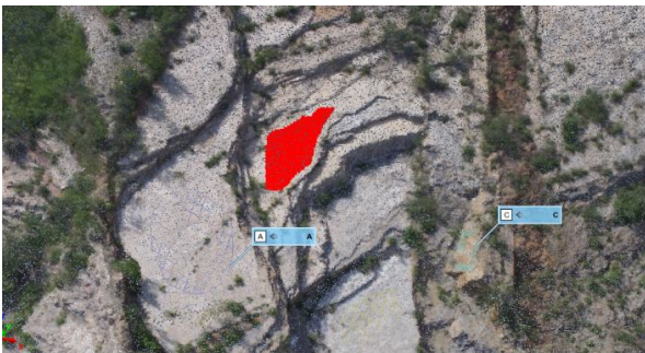
图 5 点云模型中的结构面拟合
