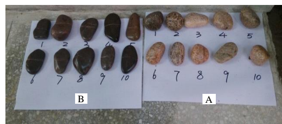
图 4 粒径为 40~60 mm 的部分粗粒料蜡封后照片 Fig.4 Coarse granules between 40~60 mm after wax-coated
