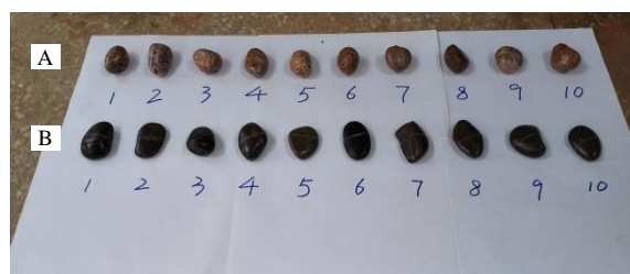
图 3 粒径为 20~40 mm 的部分粗粒料蜡封后照片 Fig.3 Coarse granules between 20~40 mm after wax-coated
