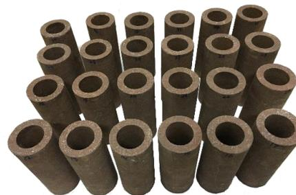
图 3 空心圆柱岩石试样
