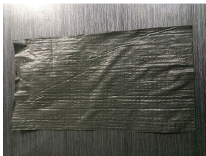
图 3 土工编织布 Fig.3 Woven geotextile
