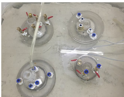
图 16 吸力桩模型沉贯结果
