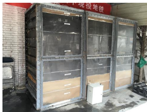
图1 试验模型箱 Fig.1 Model test box
