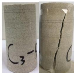
图 1 典型破坏前后岩样照片
