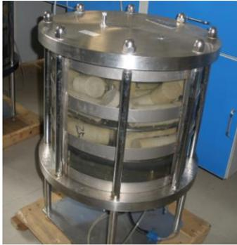
图 3 YRK-1 岩石溶解试验仪<sup>[16]</sup>
