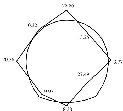
图 7 锦屏二级水电站绿泥片岩洞段衬砌钢筋应力监测结果 (单位: MPa, 拉正、压负)
