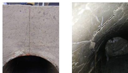
(a) 边缘裂缝 (b) 洞顶破坏
