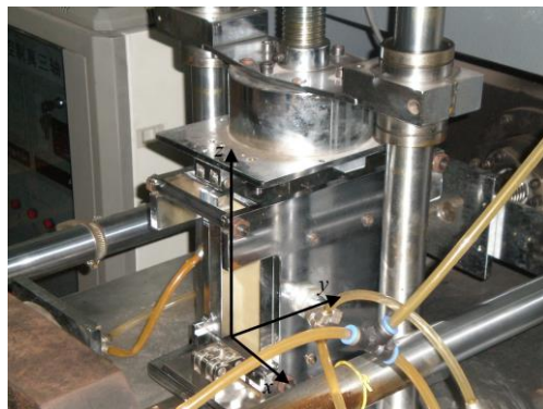
图 3 试样安装图
