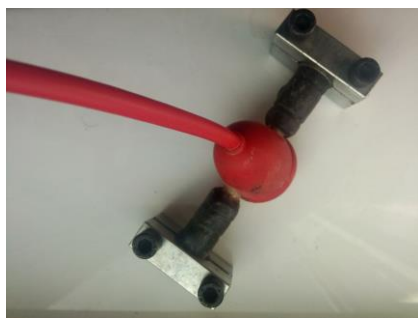
图 2 振弦式表面应变计
