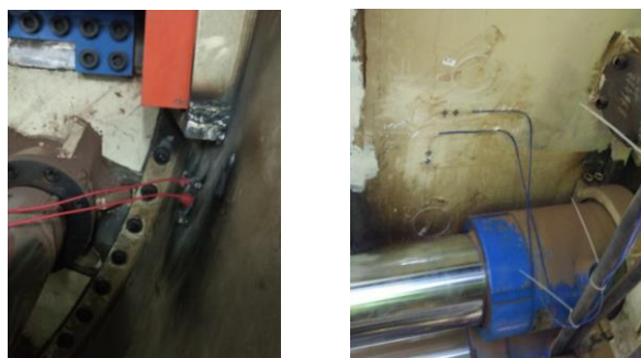
(a)安装的振弦式表面应变计
