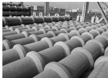
图1 竹节桩示意图
