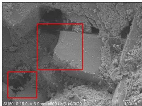
(b) 砂岩 4 超临界 CO<sub>2</sub> 冲蚀扫描图像
