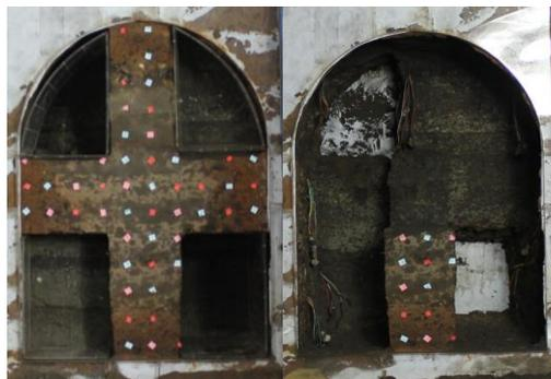
图 5 模型隧道开挖照片
