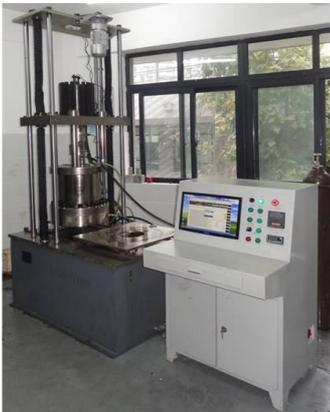
图 1 煤岩热-流-固耦合试验系统
